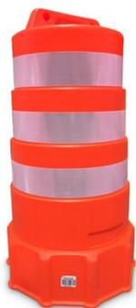
Cilindro vial reflectorizada con láminas de cono serie 3340 las cuales cumplen con los requisitos MUTCD para uso en carreteras y servicios públicos, y excede los valores de reflectividad de ASTM Tipo V para la reflectación del tráfico. Estas cintas son de 6" ancho (15 cm aprox) por cada tramo, hechas de polietileno de media densidad (MDPE).
